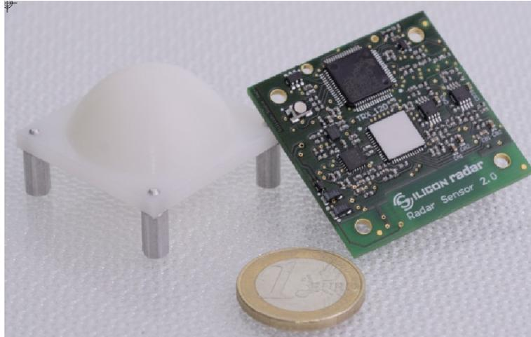
Abb. 12: Evaluation Kit für 120 GHz FMCW Radar von Silicon Radar [11] mit dielektrischer Linse
