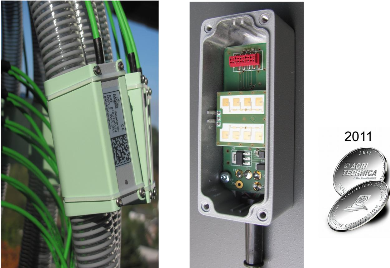
Abb. 4: MSO SeeDector Sensor montiert (links); MSO SeeDector Sensor offen (Mitte); Auszeichnung des SeeDector mit der Silbermedaille der DLG Neuheitenkommission zur Agritechnica 2011 (rechts), Firmenphotos MSO
