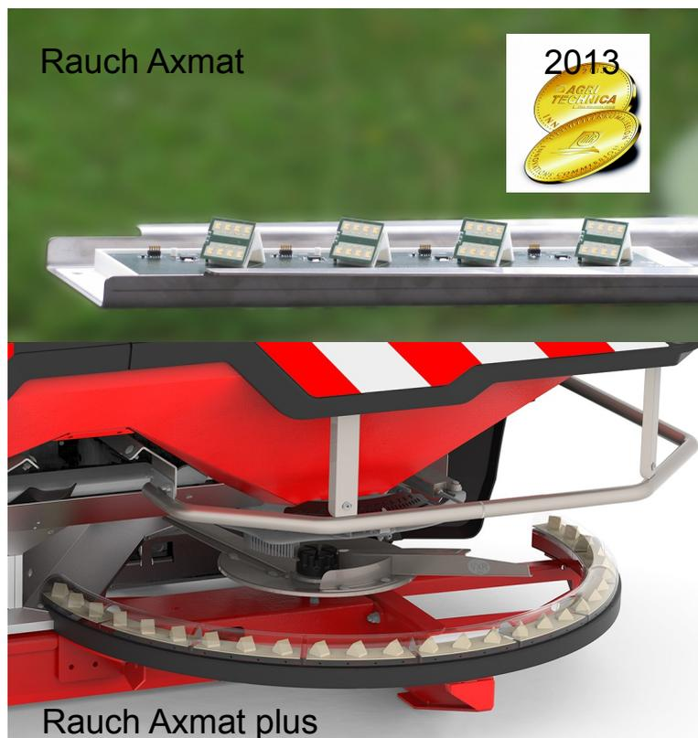
Abb. 6: Rauch Axmat Bild oben : Schwenkarmsystem zur Erfassung der Querverteilung am Schleuderstreuer (Firmenphoto MSO); unten : Rauch Axmat plus als ortsfestes Ringsegment mit 27 Radarsensoren (Pressephoto Rauch)
