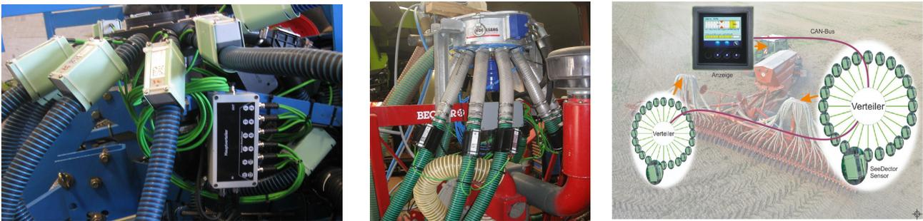
Abb. 5: MSO SeeDector Sensoren an einer Sämaschine (links) und einem Gülleverteiler (Mitte), Integration im System MSO SeedMon zur Blockadeüberwachung (rechts) [5]
