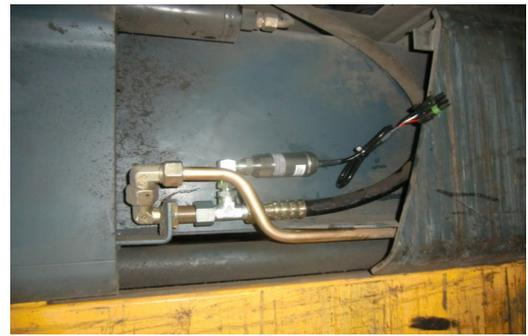
*Abbildung 3: Montage mit T- Stück und Sensor*
