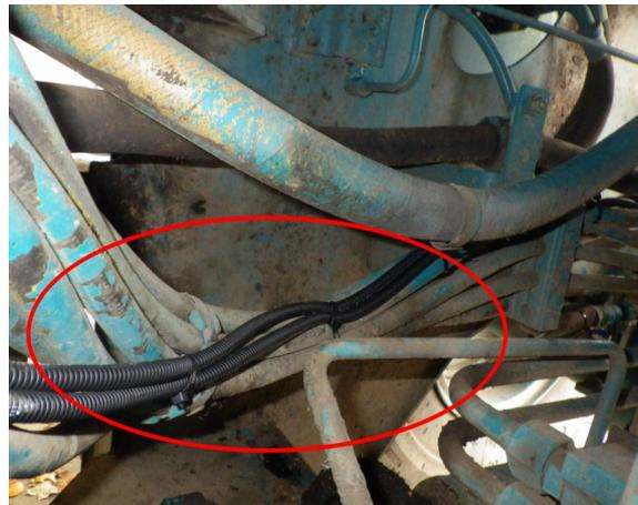
*Abbildung 24: Kabel alle 30cm befestigen!*
