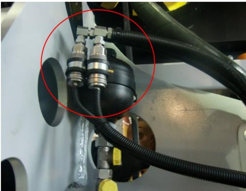
Abbildung 11: Drucksensoren am Halter der Stickstoffblase
