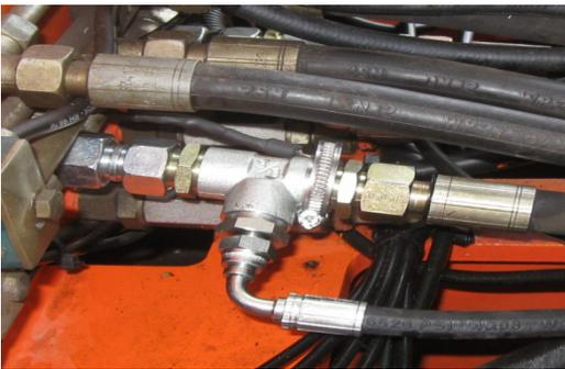
*Abbildung 2: Montage mit T- Stück und Schlauch*
