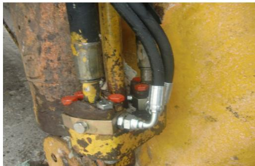
*Abbildung 4: Montage mit „SAE“-Flansch und Schlauch*
