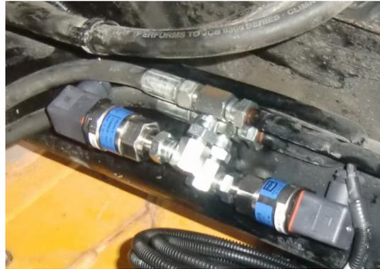
Abbildung 7: Montage direkt mit Winkel an das T- Stück
