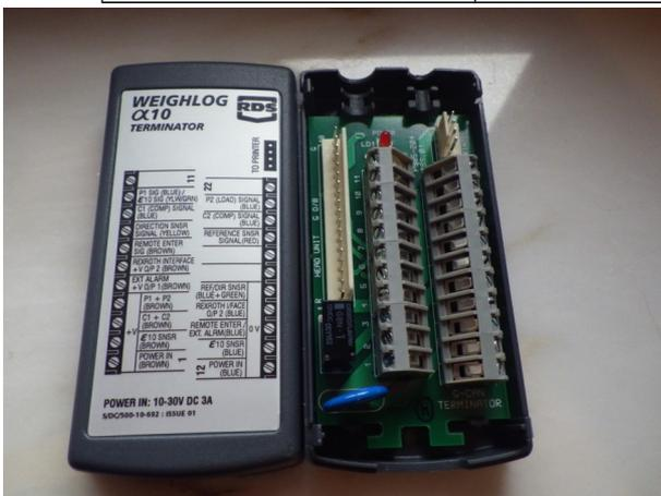
Abbildung 36: „Terminator“- Anschlussbox
