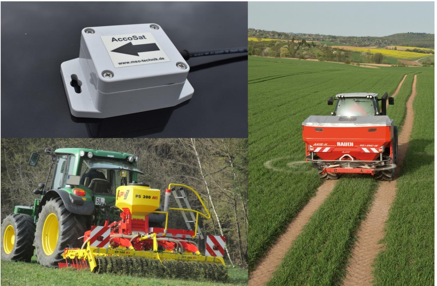
Der **AccoSat** Sensor misst die wahre Geschwindigkeit von Fahrzeugen und Anbaugeräten in Echtzeit mit hoher Dynamik.
