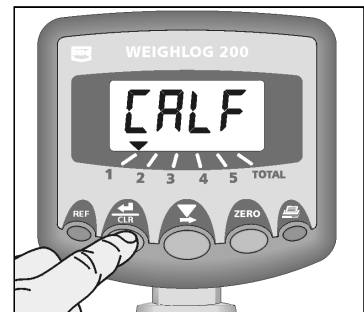
Bild 22 :Setzen des anfänglichen Cal Faktors
